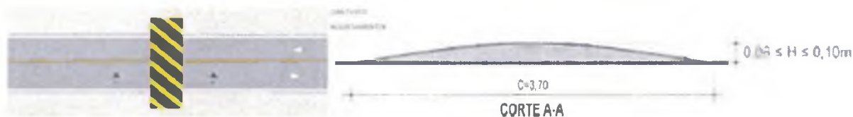
Figura 52. Dimensões de ondulação transversal tipo A.
