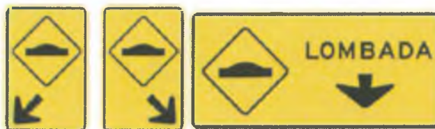
Figura 54. Sinalização de advertência aplicada em lombadas.
