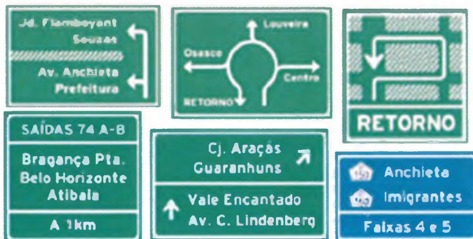
Figura 37. Placas de orientação de destino.
