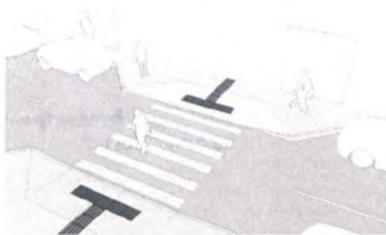
Figura 101. Avanço de calçadas.
