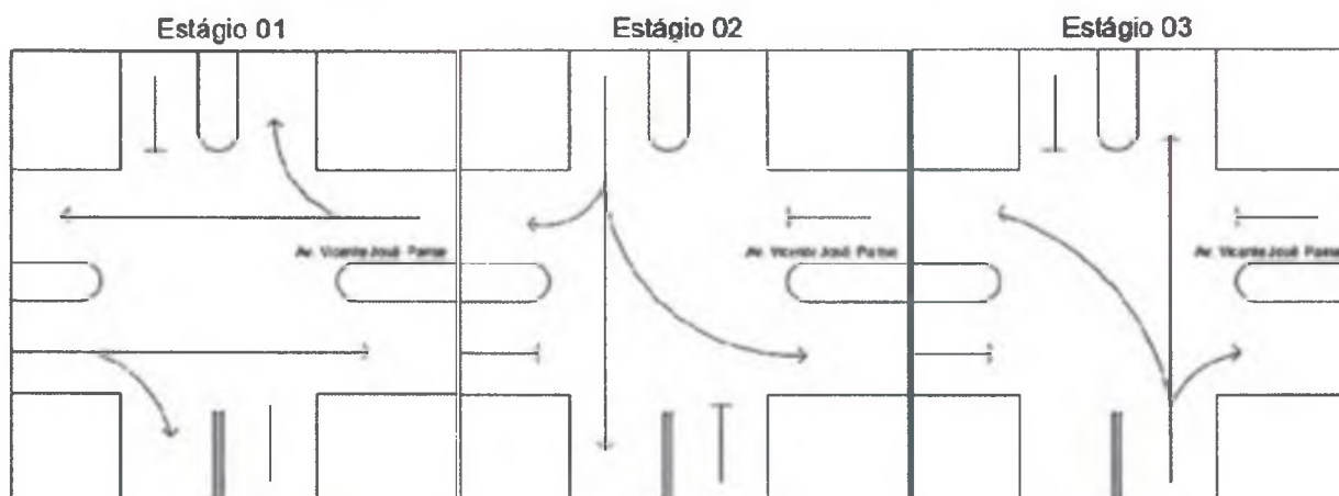
Figura 24. Estágios de um semáforo de três tempos.
