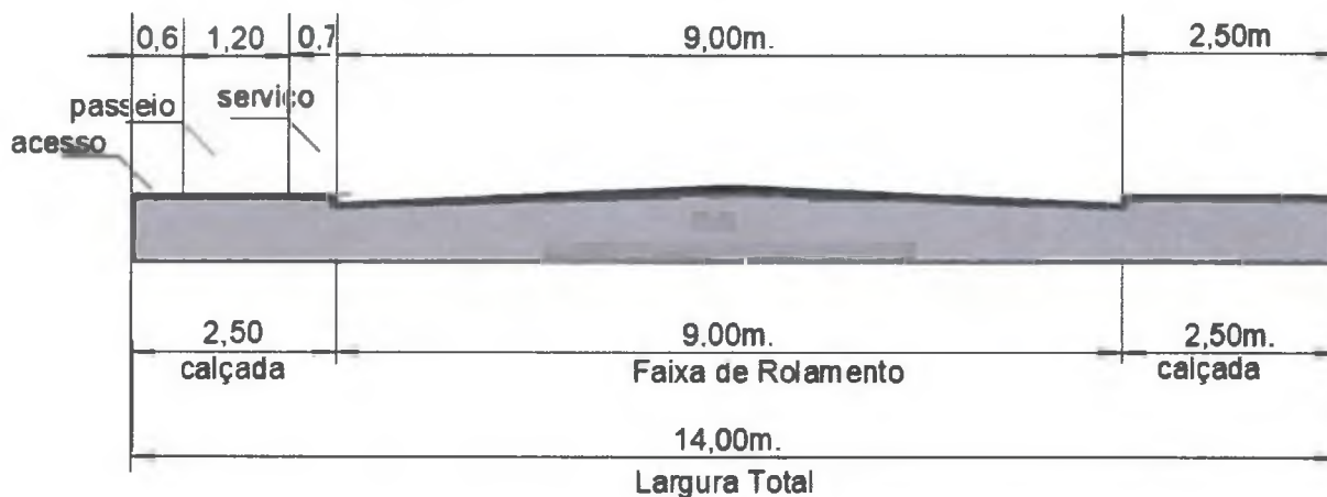
Figura 85. Exemplo de seção típica de via local – Tipo 2 (Via em loteamentos abertos sem implantação de unidades habitacionais).
